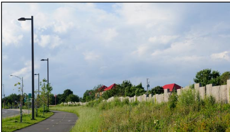
PHOTOS 14-15 Butte et mur antibruit fait de dalles de granit récupérées. À remarquer la gestion de la végétation de type extensive
