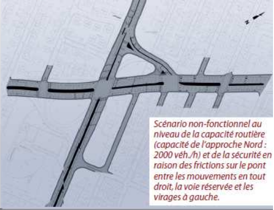
Scénario 3B : Création de trois intersections à niveau sans travaux sur le pont
