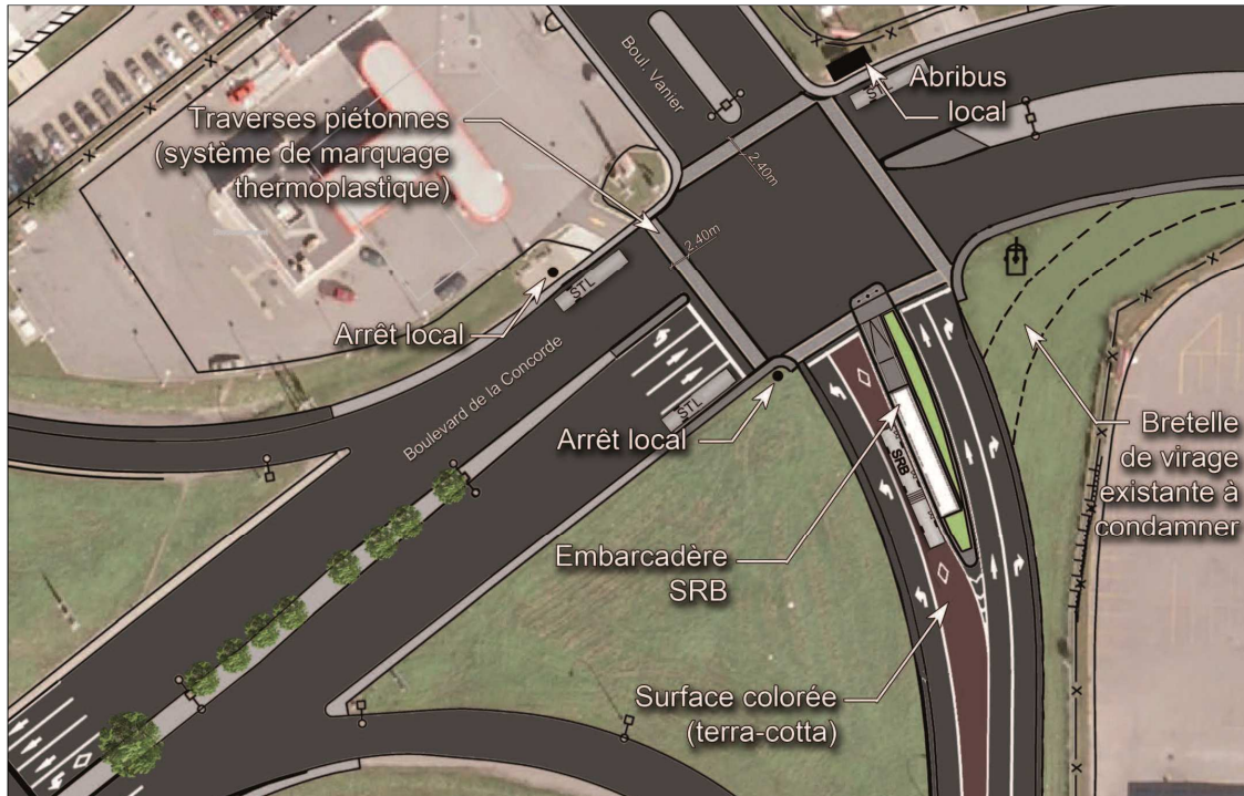
Figure 2-4 Aménagements de l'échangeur Concorde proposés
