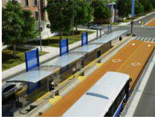
Figure 3-2 Chaussée colorée des voies réservées du SRB Pie-IX
