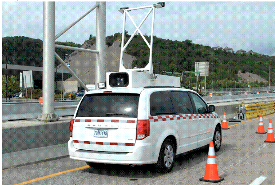
Figure 6 : Radar photo mobile utilisé dans les zones de travaux
