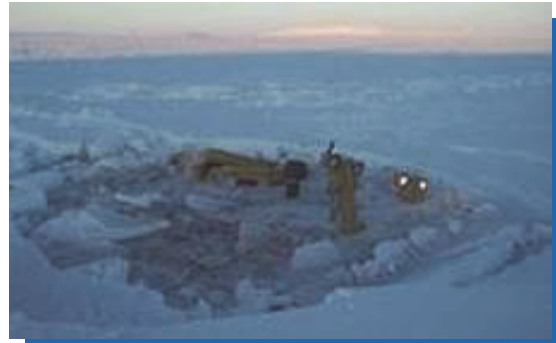
FIGURE 6-2 : Tracteur D10 de Caterpillar qui s'enfonce dans une fissure circonférentielle
