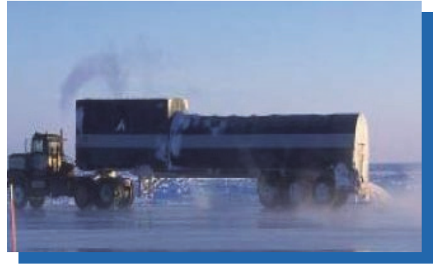
FIGURE 7-3 : Camion-citerne qui épand de l'eau sur la neige (avec la permission de l'AIC)
