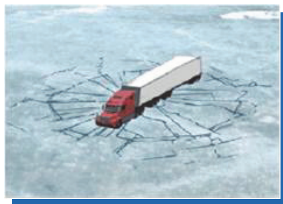
FIGURE 6-1 : Fissures radiales et circonférentielles qui se forment sous un véhicule
